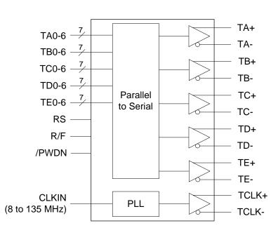
TRIPLE 10-BIT LVDS TRANSMITTER FOR VIDEO
